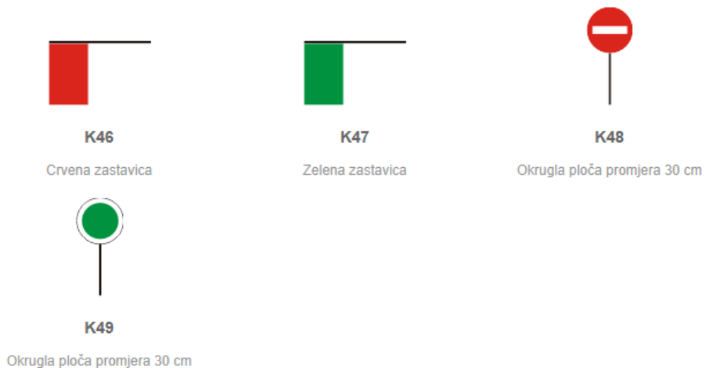
Slika 2. Prometna oprema za privremenu (ručnu) regulaciju prometa – zastavice i okrugle ploče
